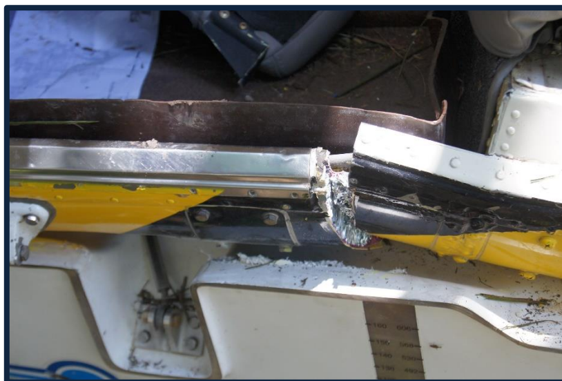
Fotografía No. 13 Parte inferior del fuselaje fracturado.
