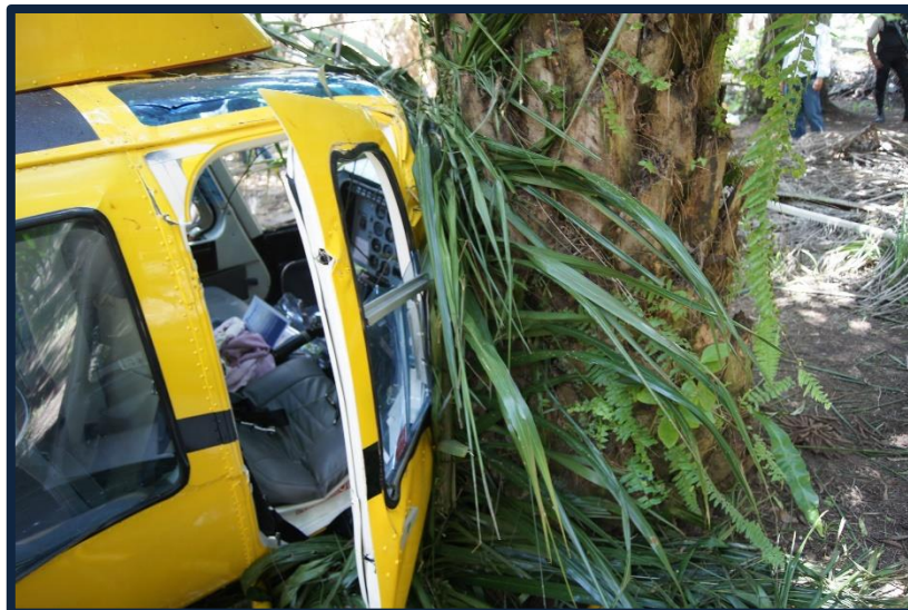
Fotografía No. 8 Vista de los daños de la puerta derecha.
