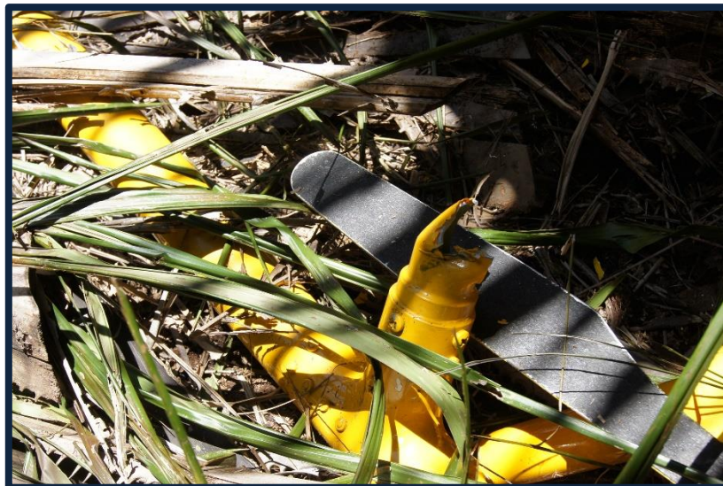
Fotografía No. 6 Daños en el tren de aterrizaje, en los tubos cruzados y deslizadores.
