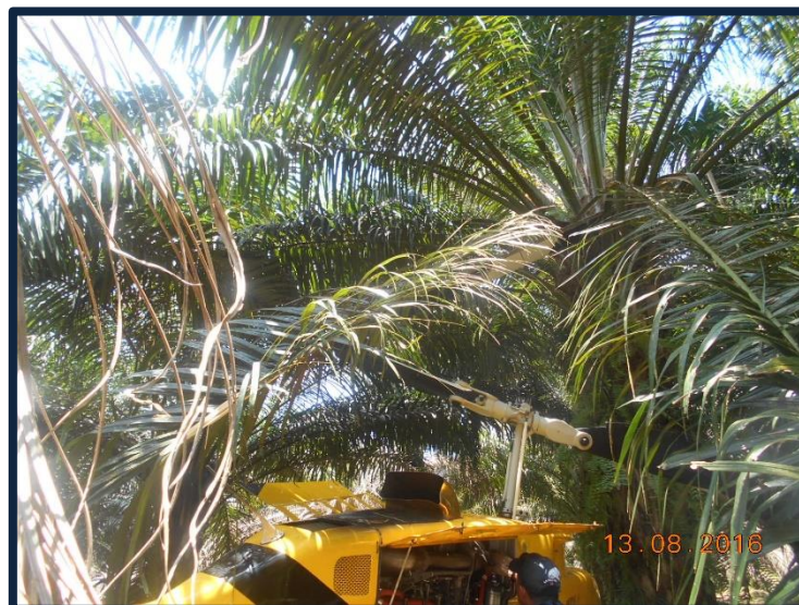
Fotografía No. 16 Vista del rotor principal impactando con una palmera.
