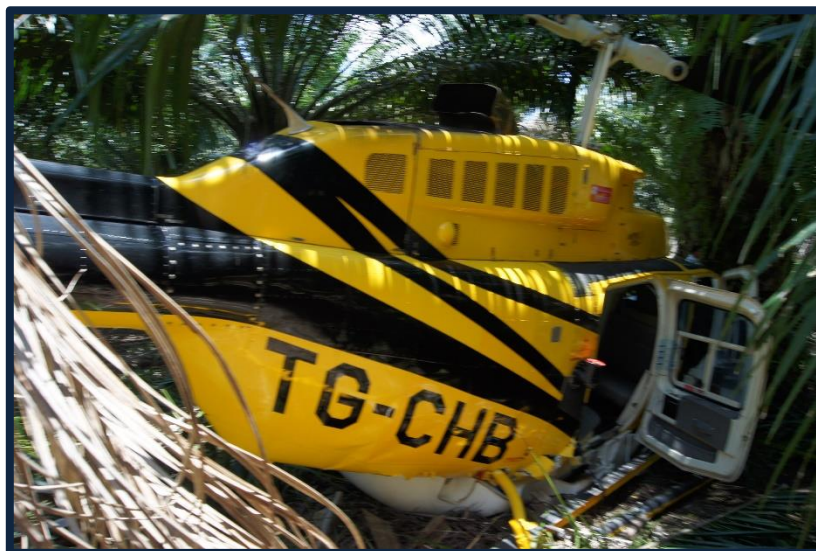
Fotografía No. 4 Vista lateral derecha del helicóptero, dañado por impacto severo.
