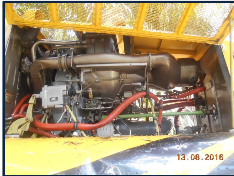
Fotografía No. 15 Vista del motor, no presenta daños externos.
