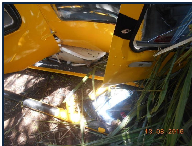
Fotografía No. 18 Vista de daños en el fuselaje lado derecho.
