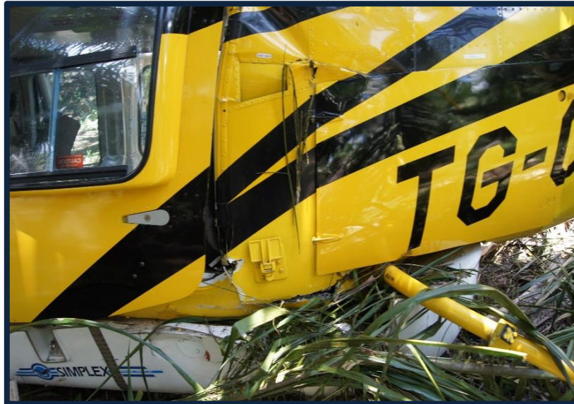
Fotografía No. 11 Vista lateral izquierda del helicóptero y fuselaje dañado.
