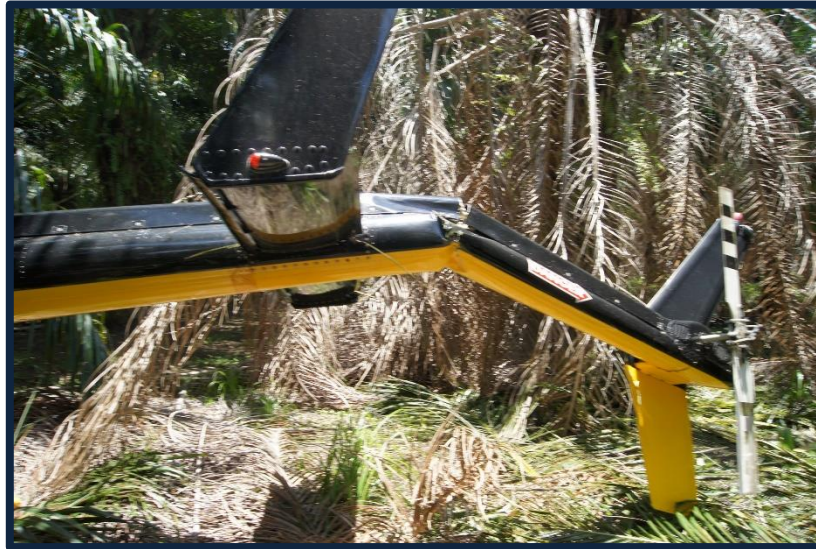
Fotografía No. 3 Botalón fracturado y ejes de transmisión dañados.
