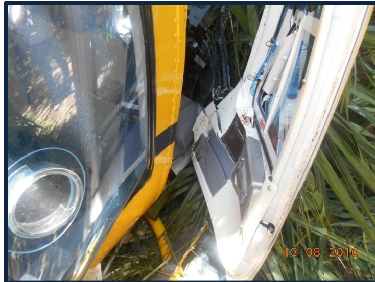
Fotografía No. 17 Vista de los daños en puerta delantera derecha.
