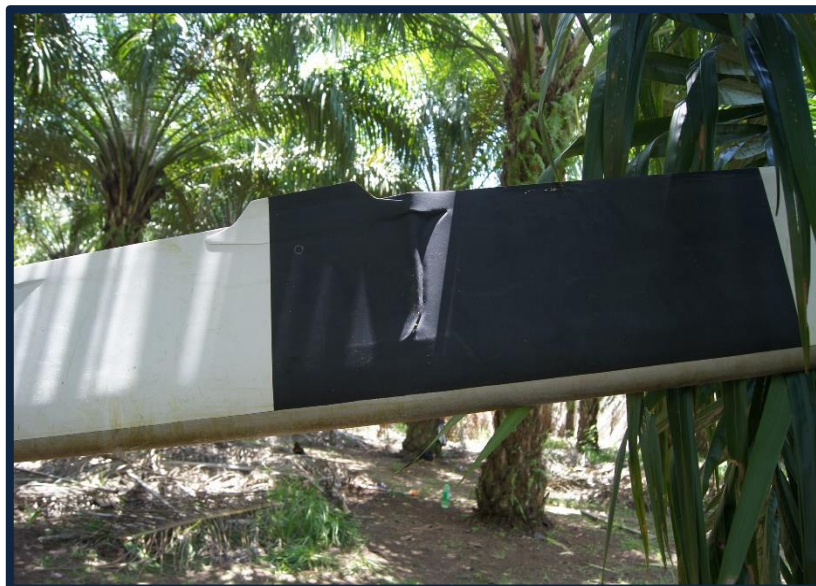
Fotografía No. 10 Un aspa del rotor principal con daños severos.
