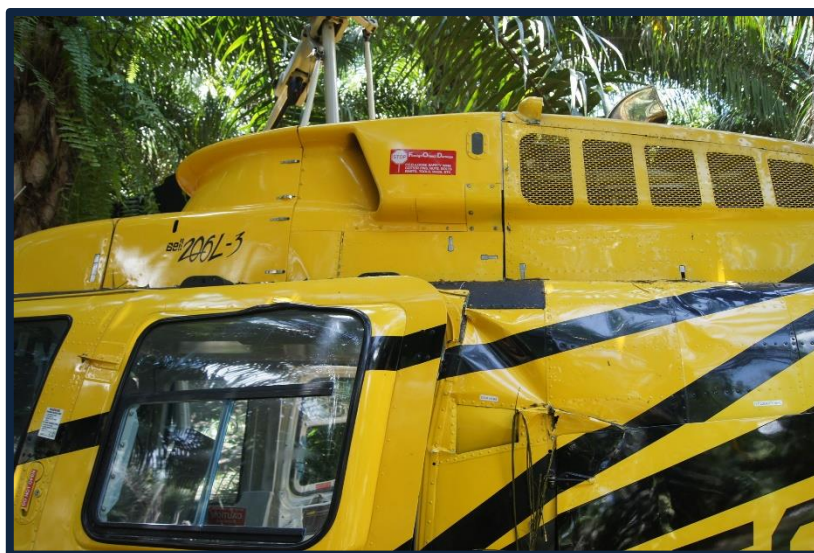
Fotografía No. 12 Daños en la estructura por compresión provocados por la caída.
